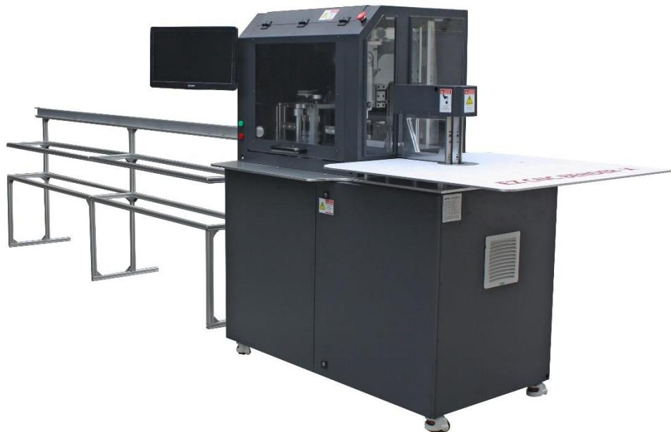
**EZLETTER EZBENDER-X** je najpopularniji savijač traka i profila od aluminija i nehrđajućeg čelika koji koristi samo najkvalitetnije komponente: vodeće japanske Panasonic servo motore (4 motora) i 1 motor od vodećeg kineskog proizvođača Leishine, noževi su izrađeni od švedskog čelika – provjерено najbolja rješenja današnjice.
